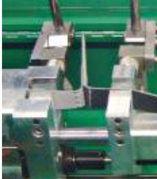
Испытание сварного шва при помощи EXAMO USB
